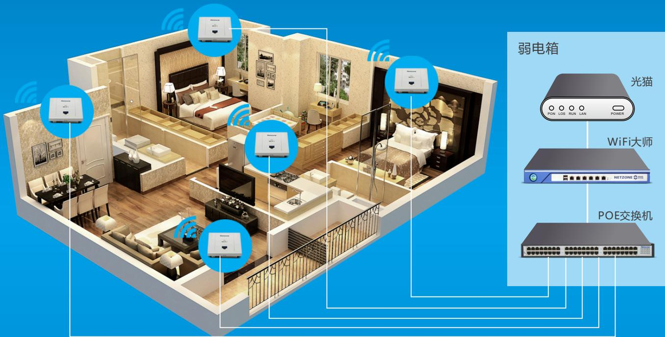
主路由采用企业级网关——WiFi大师，性能强悍，功能强大，稳定性非常高，多WAN口的设计可以提供多个外网连接，上网速度翻倍。主交换机采用POE千兆交换机，能满足大型数据传输的稳定高速传输要求，无线网络覆盖全部采用支持千兆网络的无线面板式AP——NZ300，通过6类网线直接接到千兆POE交换机，不需单独连接电源。
